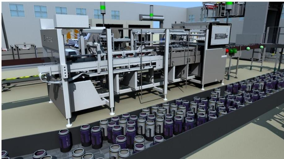
**Emulate3D** je softverski sistem za digitalnu simulaciju automatizovanog rada. To je razvojno okruženje za kreiranje digitalnih blizanaca pojedinačnih uređaja za automatizaciju, koji se zatim koriste za simulaciju njihove interakcije i komunikacije podataka u 3D grafičkom okruženju.
